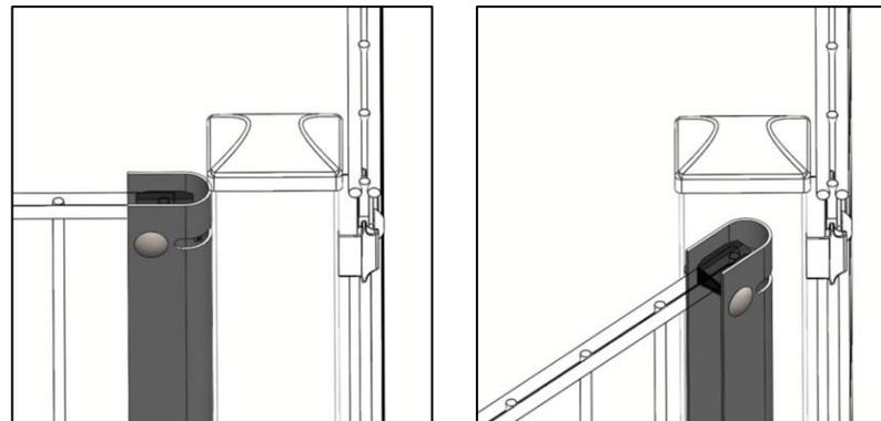
Die variable Zaunanschlussleiste zur Realisierung von Zaunanschlüssen in veränderbaren Winkel. Ermöglicht in Verbindung mit Ihrer Zaunanlage einen frei wählbaren Winkel. (inklusive Befestigungsmaterial)
